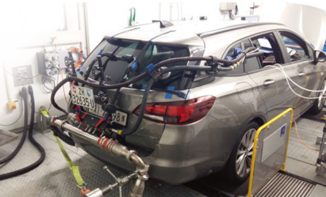
Ein Opel Astra 1.6 CDTI auf dem Rollenprüfstand der Empa. Die Schläuche verbinden den Auspufftrakt mit einem mobilen PEMS-Messgerät im Inneren des Autos. In der gleichen Konfiguration geht es dann auf die Strecke rund um den Greifensee.
