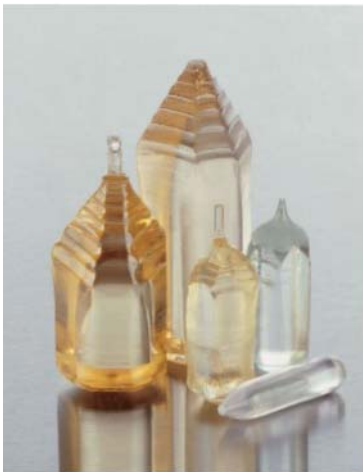
Der von Kistler Instrumente AG gezüchtete Quarzkristall, das Herzstück der piezoelektrischen Drucksensoren (Bild Kistler AG, Winterthur).
