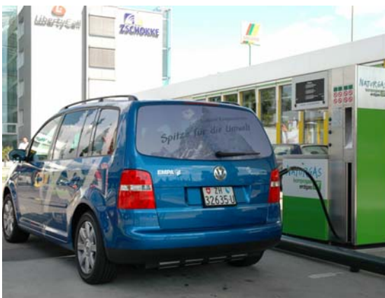
An einer der rund 60 in der Schweiz vorhandenen Erdgastankstellen wird das auf «echten» Erdgasantrieb ausgerüstete Empa-Versuchsfahrzeug betankt.
