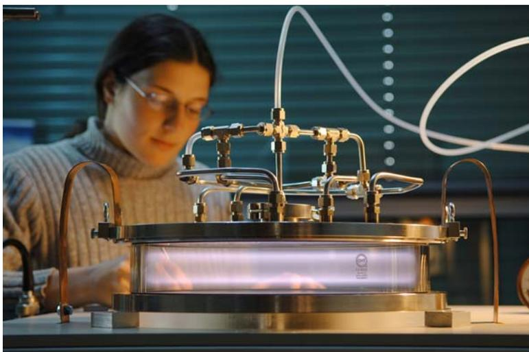
Zur Bekämpfung von Krankenhauskeimen werden medizinische Textilien dank Plasmatechnik mit einer nanometerdicken Silberschicht versehen, die die Besiedlung von Mikroorganismen wesentlich eindämmt. Im Bild eine Labor-Versuchsanlage an der Empa.
