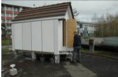
An diesem Modellhaus messen Forscher von Eawag und Empa, wie Regen Biozide auswäscht, welche zum Schutz vor Pilzen und Algen in Fassadenfarben und Putzen enthalten sind.
