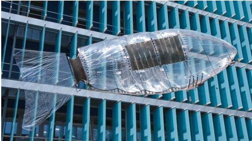
Das Empa-Luftschiff «Blimp» bewegt sich wie eine Forelle im Wasser: An der Hülle und den «Flossen» befinden sich EAP-Aktuatoren.
