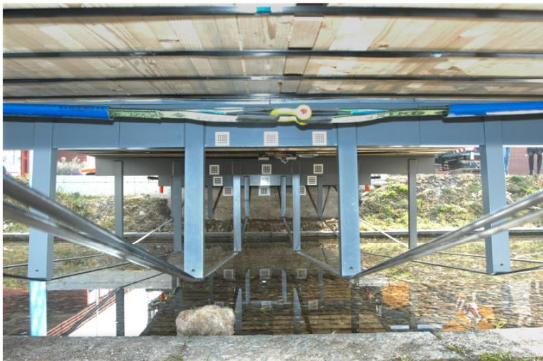
Système vidéo de mesure des déformations installé sur un pont de bois en poutres lamellées collées soutenu au moyen de tirants en polymère renforcé de fibres de carbone (PRC).
