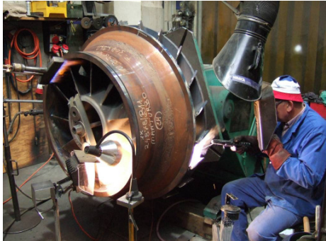
Soudage de la turbine d'un turbocompresseur. (Photo: MAN Turbo)
