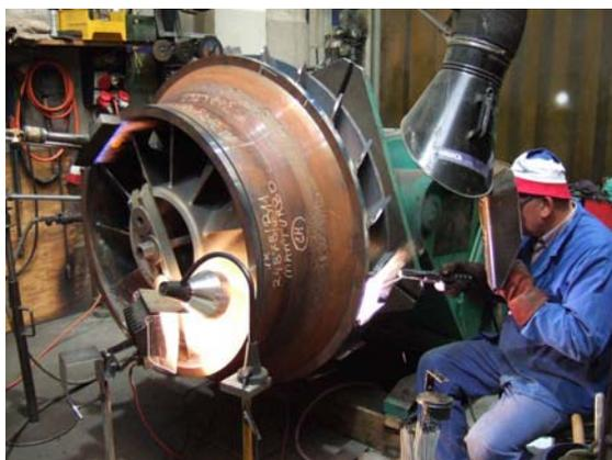
Schweissen des Laufrades eines Turbokompressors. (Bild: MAN Turbo)
