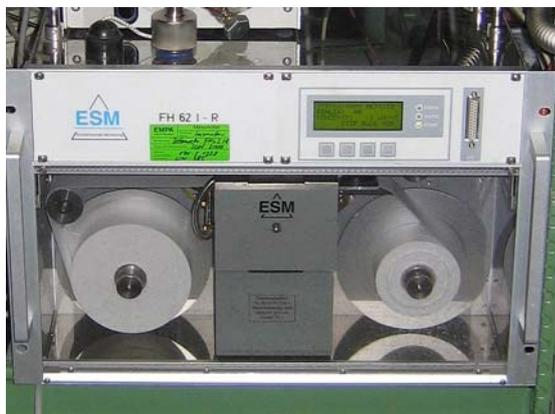
Analysegerät (Betameter) zur Messung von Feinstaub auf dem Jungfraujoch, einer Messtation des NABEL (Nationales Beobachtungsnetz für Luftfremdstoffe).
