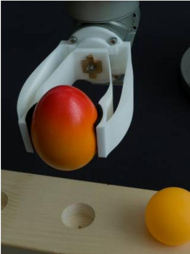
Aus intelligenten, nachgiebigen Materialsystemen lassen sich preiswerte Werkzeuge herstellen. Der Greifarm dieses Roboters ist aus einem Guss gefertigt.
