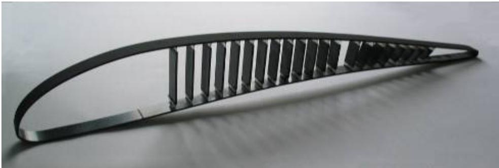
Mit nachgiebigen Systemen lässt sich eine anpassungsfähige Flügeltragstruktur konstruieren, welche aus einem Guss besteht.
