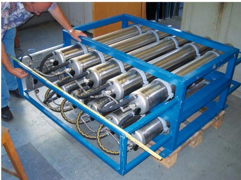
Module d'accumulateur à hydrure embarqué sur le «Ross Barlow».
