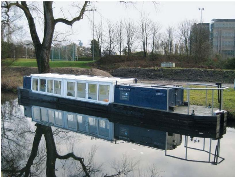
Le bateau fluvial à hydrogène transformé équipé d'un accumulateur à hydrure de l'Empa.
