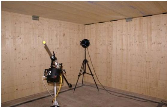
Messinstrumente ermitteln in einer Leichtbaukonstruktion aus Holz die verschiedenen Übertragungswege für den Schall.
