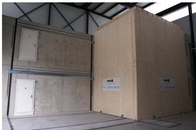
Une construction en bois à deux étages élaborée dans le banc d'essai pour construction légère, permettant de mesurer la propagation du son d'une pièce à l'autre.
