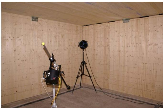
Des instruments de mesure déterminent les différentes voies de propagation du bruit dans une construction légère en bois.
