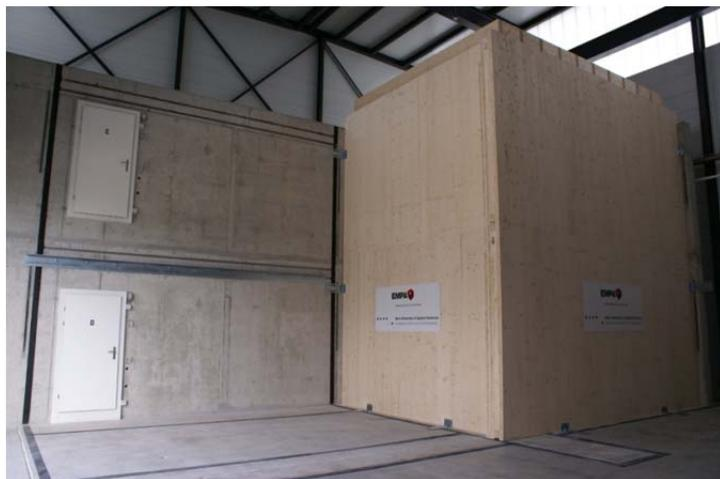
Ein im Leichtbauprüfstand aufgebauter zweigeschossiger Holzbau, an dem die Schallausbreitung von einem Raum auf den anderen gemessen werden kann.
