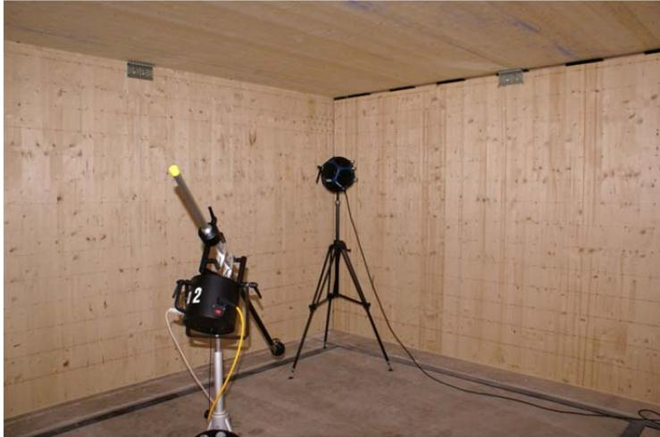
Messinstrumente ermitteln in einer Leichtbaukonstruktion aus Holz die verschiedenen Übertragungswege für den Schall.
