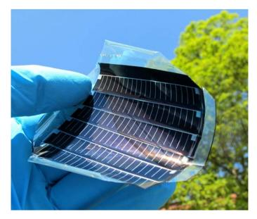
Monolithisch verschaltetes, flexibles Solarmodul aus 6 Zellen auf Cadmiumtelluridbasis (CdTe), mit dem Empa-Forschende den Wirkungsgrad auf den neuen Rekordwert von 13,8 Prozent steigerten.
