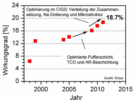
Verbesserung in der Effizienz der Energieumwandlung von flexiblen CIGS-Polymersolarzellen.
