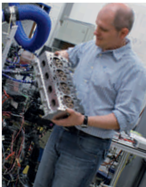
Projektleiter Patrik Soltic inspiziert einen Zylinderkopf, der für die Wasserstoff-Erdgasversuche eingesetzt werden soll. Im Hintergrund ist der Empa-Prüfstand für Vierzylindermotoren zu sehen.
