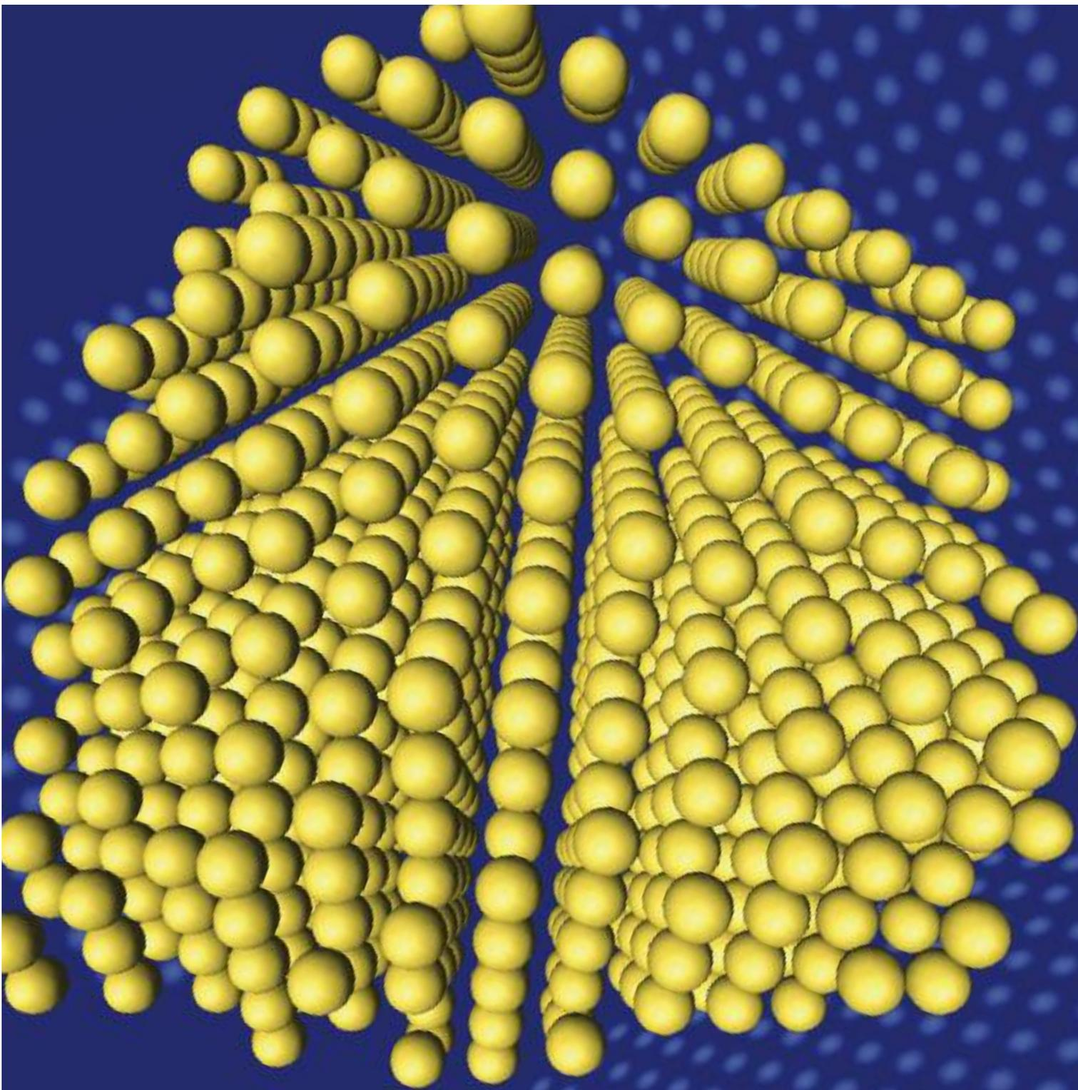
Erstmals ist es Forschenden gelungen, die Anordnung der einzelnen Atome und deren Anzahl in einem Nanopartikel zu bestimmen. Das Silberpartikel hat einen Durchmesser von rund zwei Nanometer. (Bild Empa/ETH Zürich)
