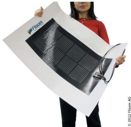
Von der Empa und Flisom AG entwickelte flexible Polymer-Dünnschichtsolarzelle (kurz CIGS). (Bild: Flisom)
