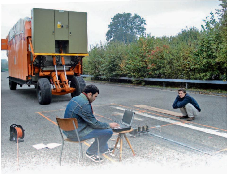
werden. Die Stahlwolle wird heiss, erhitzt das umgebende Bitumen, bei 80 Grad Celsius fängt der Asphalt an zu «schmelzen» und verfestigt sich beim Abkühlen im Inneren wieder zu einer geschlossenen Masse. Der Belag hat sich (fast) von selbst wieder repariert.
