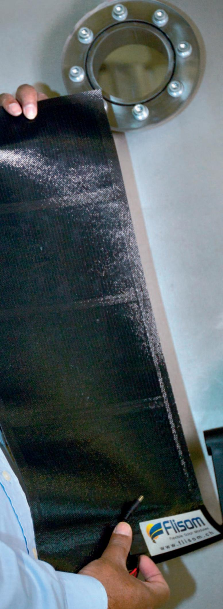
Der Empa-Solarforscher Ayodhya Tiwari ist zugleich Start-Up-Unternehmer. In den grossen Vakuum-Verdampfungsanlagen seiner Firma lassen sich flexible Dünnschichtsolarezellen von beträchtlicher Grösse herstellen. Zugleich forscht Tiwari mit seiner Arbeitsgruppe weiter an den Grundlagen der Technologie.
