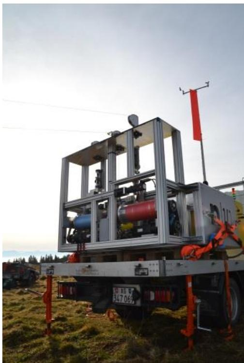
La station au sol est mise en place. Le cerf-volant est fixé aux manivelles et maintenu en l'air, tandis que la traction ainsi exercée est transformée en courant.
