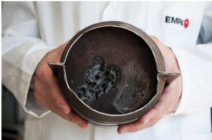
Ce catalyseur nid d'abeille d'une voiture de course a donné aux chercheurs de l'Empa l'idée de développer le catalyseur mousse: dans une zone, le monolithe a fondu alors qu'il est intact juste à côté, ce qui est le signe d'une mauvaise répartition des gaz d'échappement.
