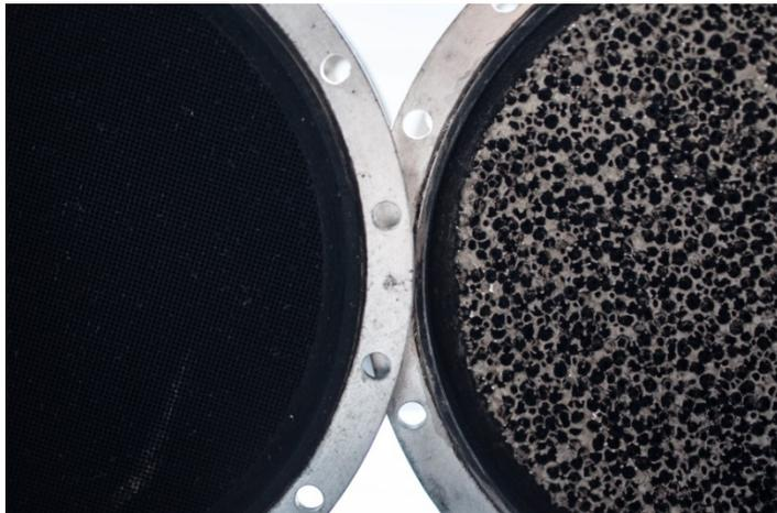
Traditionnel contre innovateur: à gauche un catalyseur monolithique, à droite un catalyseur mousse.
