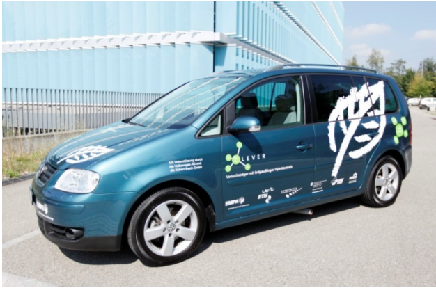
CLEVER, das Erdgas-hybrid-Forschungsauto der Empa und der ETH Zürich auf Basis eines VW Touran.
