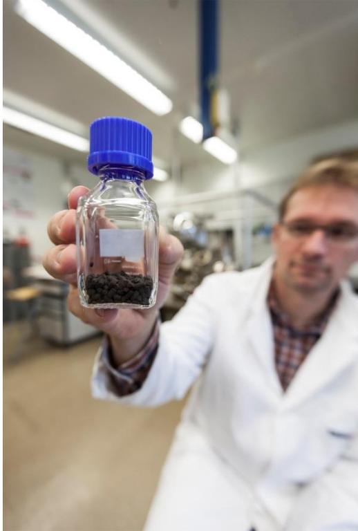
Zeolithe binden das bei der Methanisierung von Wasserstoff entstehende Wasser und erhöhen dadurch die Methanausbeute des neuen Prozesses.
