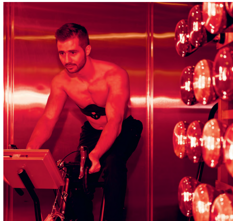
La ceinture cardio, faite d'un tissu souple et d'électrodes brodées, permet de mesurer confortablement et sur une longue durée des paramètres physiologiques importants. Image: Robert Stürmer / Empa.
