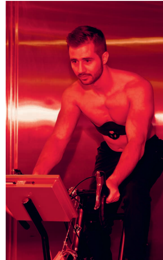
Mit dem Cardiogurt aus anschniegsamem Gewebe und gestickten Elektroden lassen sich physiologisch wichtige Parameter bequem über längere Zeit messen. Bild: Robert Stürmer / Empa
