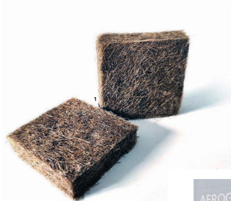
1 Dämmplatte basierend auf Algenfasern, welche an den Stränden des Mittelmeers angespült und typischerweise als Abfall entsorgt werden.
