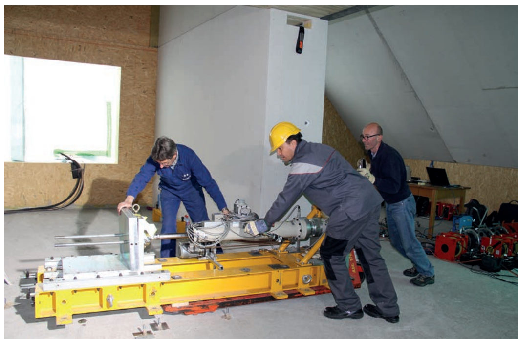
Abb. 6 Installation des Schwingers für die Rüttelversuche an einem 3-geschossigen Holzrahmenbau (Foto: Empa, Abt. Ingenieur-Strukturen)
