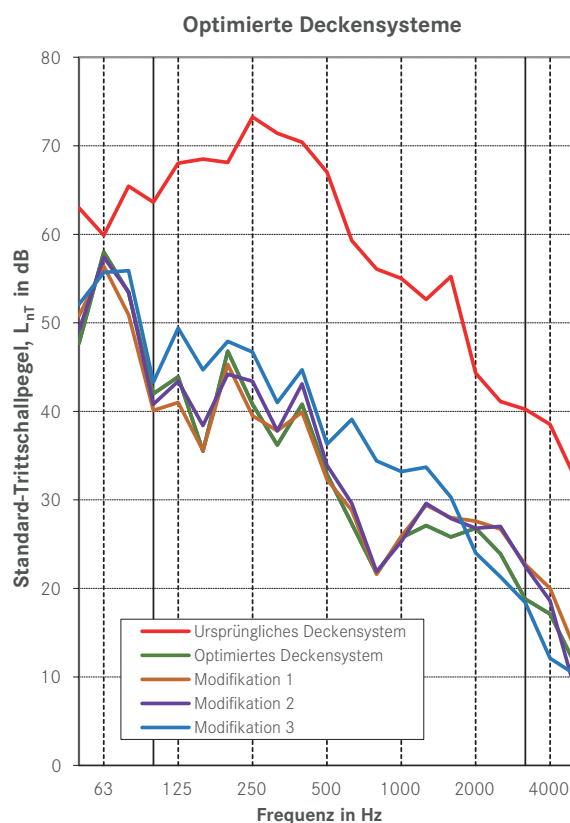
Abb. 18 Messung der Trittschalldämmung nach der Optimierung des Deckensystems
