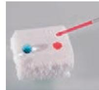
Ein neues, saugfähiges Material aus der Empa-Holzforchung könnte bei künftigen Ölkatastrophen helfen: chemisch modifizierte Nanozellulose. Der leichte Stoff saugt die Öllache auf, schwimmt auf dem Wasser und kann eingesammelt werden.
