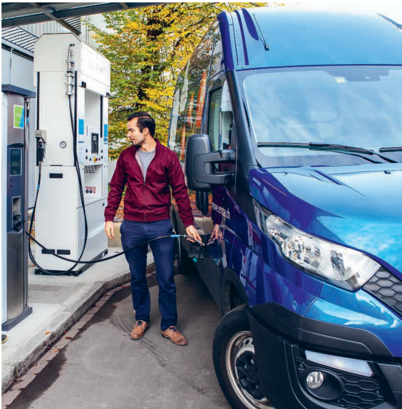
La Poste suisse teste le véhicule HGNC de l'Empa pour ses livraisons de colis. On le voit ici faisant le plein d'un mélange de méthane et d'hydrogène.
