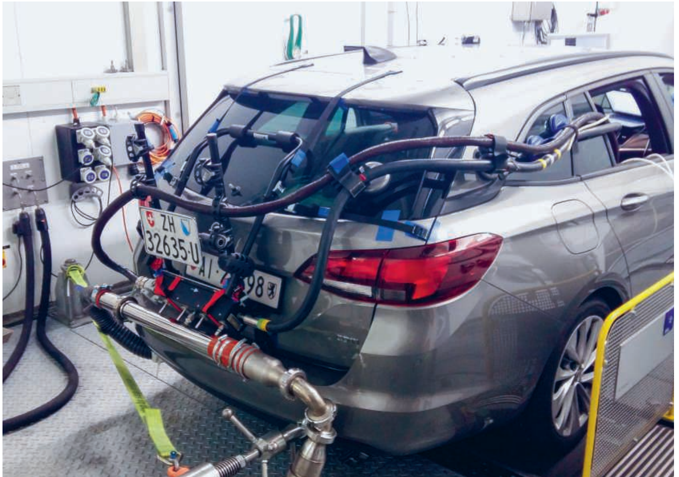
Une Opel ASTRA 1.6 CDTI sur le banc d'essai de l'Empa. Les tuyaux relient l'échappement à un appareil de mesure embarqué PEMS (Portable Emission Measuring System). Le test sur route est ensuite mené dans la même configuration.
