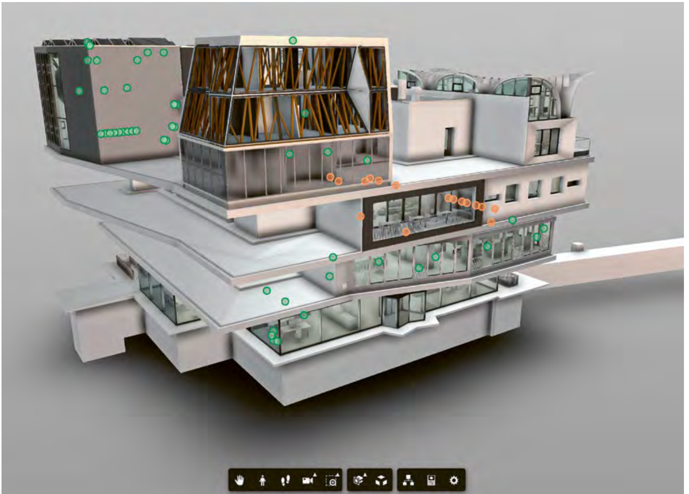
Live-Daten im 3D-Modell: Im virtuellen NEST stehen die Daten der über 700 Sensoren und Aktoren in Echtzeit zur Verfügung. Bild: Dasher 360
