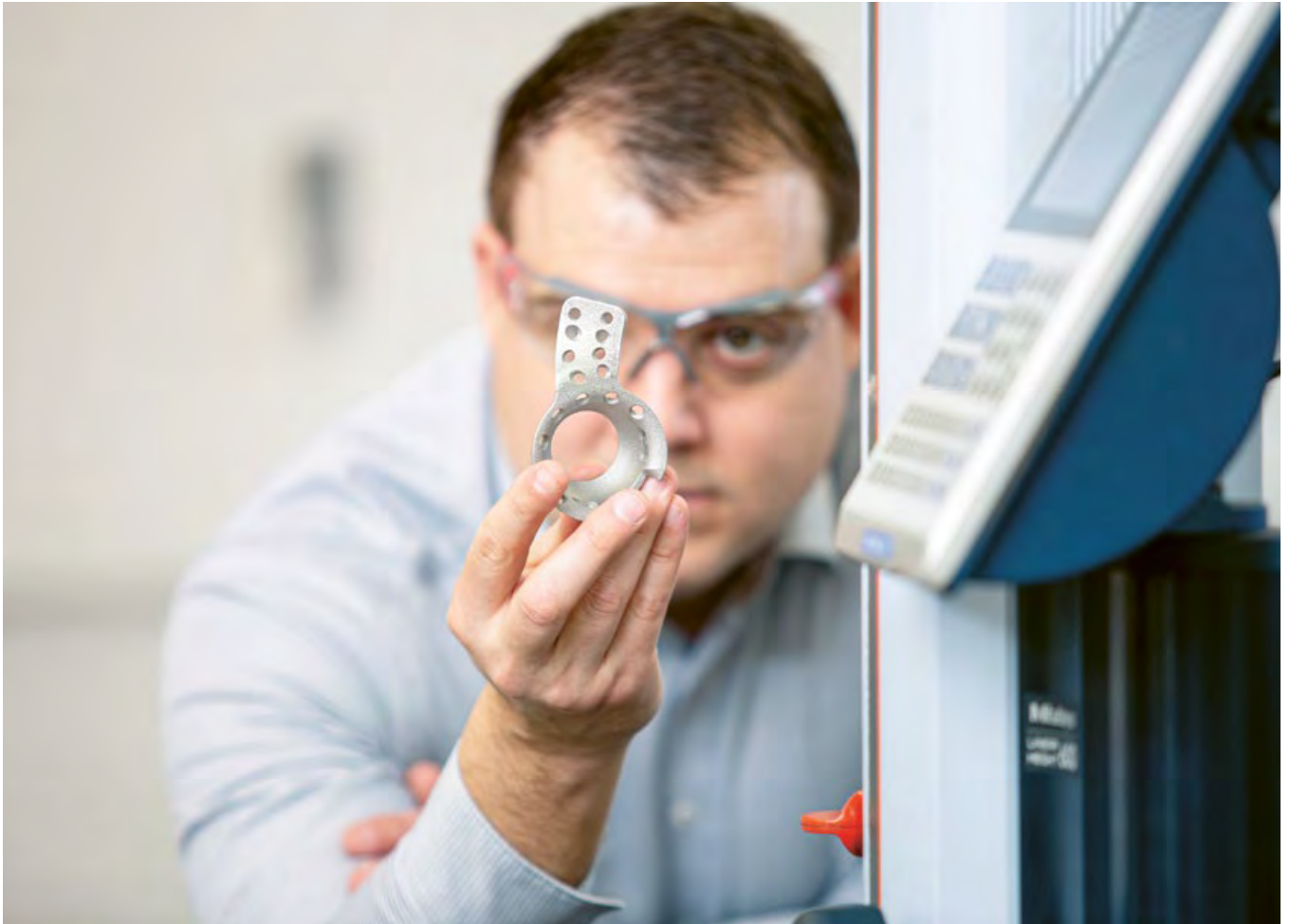
Beispiel einer 3D-gedruckten Verstärkungsplatte für die Aufnahme einer künstlichen Hüftgelenkspfanne bei komplexen Beckenfrakturen. Foto: Swiss m4m Center
