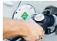
Die Empa hat die erste Wasserstofftankstelle der Schweiz für Personenvagen mit einem Fülldruck von 700 bar. Sie ist Teil des Mobilitätsdemonstrators «move» und wird für verschiedene Projektfahrzeuge der Empa sowie für Wasserstofffahrzeuge von privaten Besitzern genutzt.
