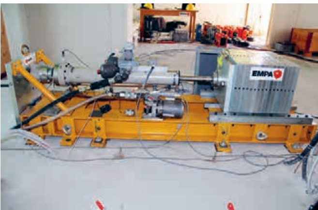
La masse oscillante de 1000 kg du générateur d'oscillations hydraulique de l'Empa est capable de mettre en vibration un bâtiment entier.
