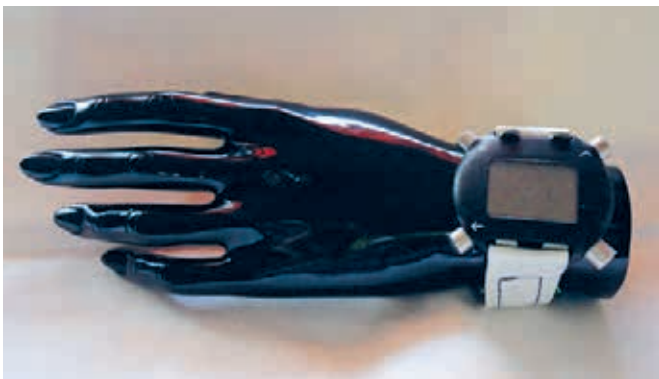
Prototype de la « montre-tensiomètre » avec son bracelet en fibres piézorésistives de l'Empa.
