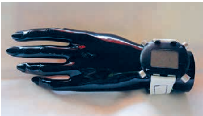
Erste Prototypen der «Blutdruck-Uhr» mit dem Empa-Band aus piezoresistiven Fasern.
