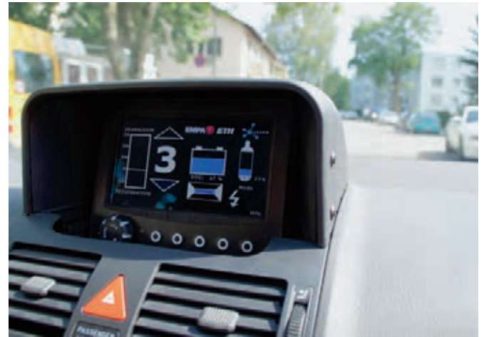
CLEVER – das Erdgas-hybrid-Forschungsauto der Empa auf der Basis des VW Touran: Monitor zur Überwachung der Fahrzustände (rechts).
