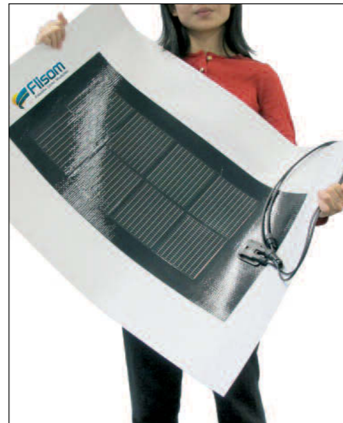
Die von der Empa und der Flisom AG, einem Spin-off der ETH Zürich, entwickelten flexiblen Polymersolarzellen waren auch Thema im Seminar «Photovoltaik im Fokus». (Flisom AG)
