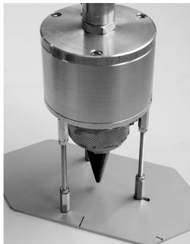
Abbildung 7.87: Quelle für die Massstabsmodellexperimente. Die Abstrahlöffnung ist am unteren Ende des schwarzen Konusses und hat einen Durchmesser von 2 mm.
