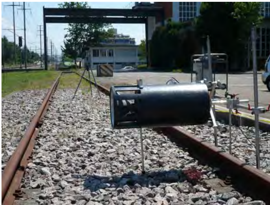
Abbildung 2.18: Schallausbreitungsexperiment auf einem Industriegleis mit dem anregenden Lautsprecher im Vordergrund und dem Mikrophon im Hintergrund.
