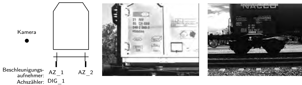
Abbildung 6.8: Messaufbau einer Monitoringstation zur indirekten Messung der Radrauheiten und Beispiele von Videoaufzeichnungen zur Erfassung der Fahrzeugnummern an Güterwagen mit v = 80 \dots 90 \text{ km/h}
