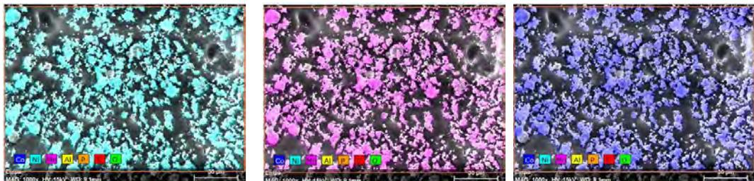
Abbildung 20 SEM Aufnahmen von Ablagerungen auf den Leiterplatten, EDX Elementanalyse Nickel (links) Mangan (Mitte) und Kobalt (rechts)
