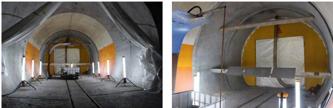
**Abbildung 8 Versuchsplatz Stollen «A» (links) mit Abluftreinigungsvorrichtung (rechts)**
