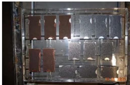
**Abbildung 15 Korrosions-Monitoring im Stollen «A»**
