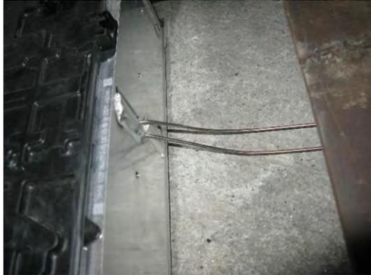
Abbildung 31 Zwei Mantelthermoelemente mit Messspitze im Zentrum des Batteriemodules
