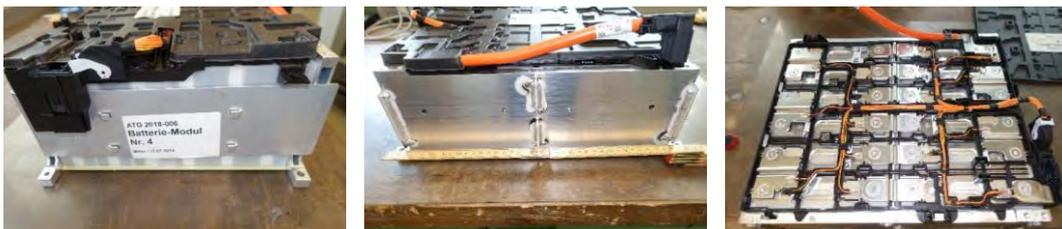
**Abbildung 24 Aufbau Batteriemodul mit untersuchten Bauteilen aus Kunststoff und Metall**
