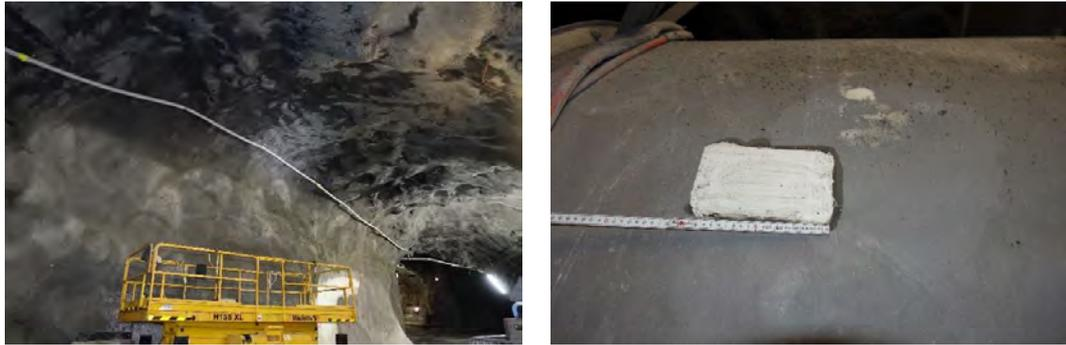
Abbildung 13 Ehemaliges Testgelände mit schwarzen Brandrussresten (links) und Probenahmestelle WP-1 am Gehäuse des Entrauchungsventilators (rechts)
