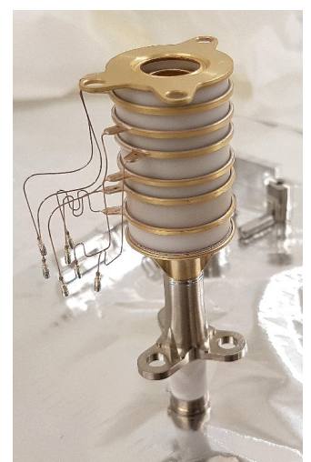
Grundkörper der Ionenquelle für ein Massenspektrometer (Bauteil mit Ag28Cu gelötet / Drähte im 2. Lötprozess fixiert)
