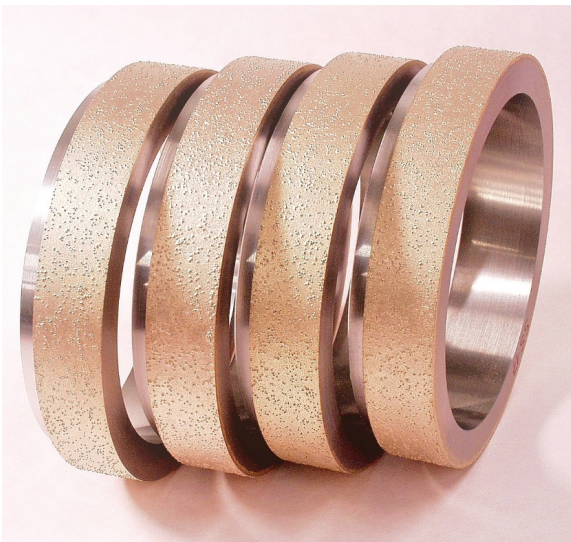
Schleifscheiben \varnothing 110 \times 18 (SS 420) / Diamant D251 / gelötet mit Cu-14Sn-10Ti (Air Brush Technik); mittlere Schichtdicke des Lotes nach dem Lötprozess: 21 \pm 2 \mu\text{m}
