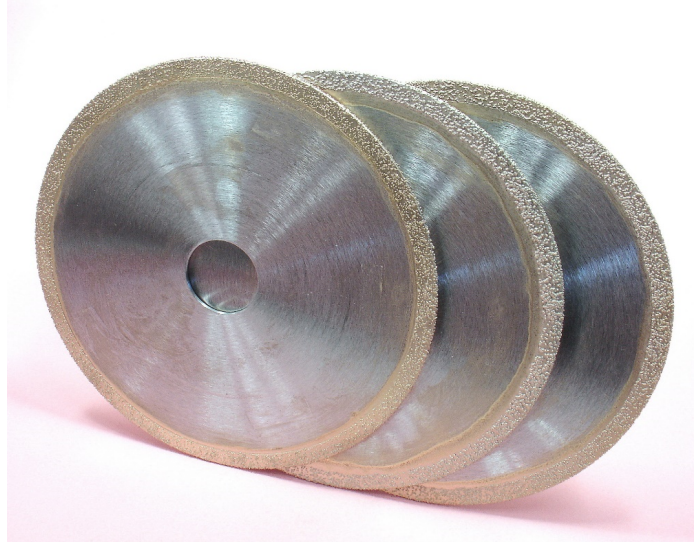
Trennscheiben \varnothing 125 \times 1.2 (C45) / Diamant D251 / gelötet mit Cu-14Sn-10Ti (Air Brush Technik)
