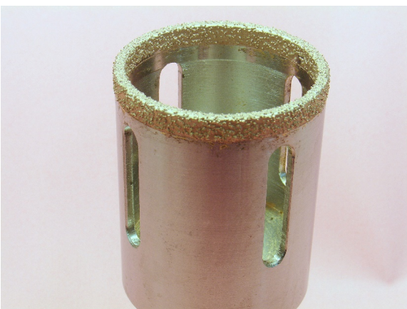
Kernbohrer \varnothing 49 \times 1.2 (C45) / Diamant D301 / gelötet mit Cu-14Sn-10Ti (Air Brush Technik)
