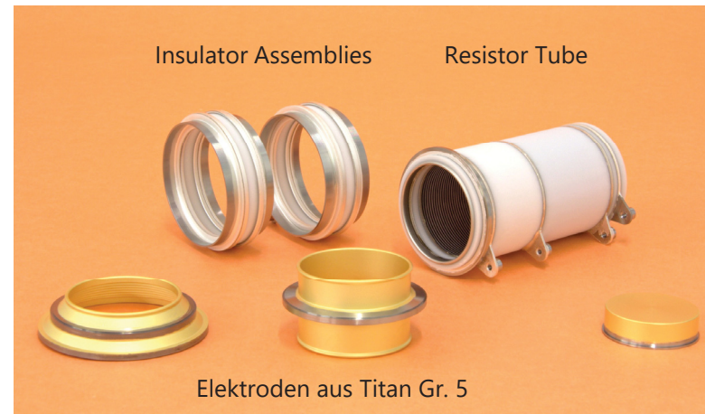
Teile vor dem Elektronenstrahlschweißen
