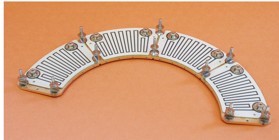
Beheizbare Struktur (Flugmodell, m = 40 g / 2010)
