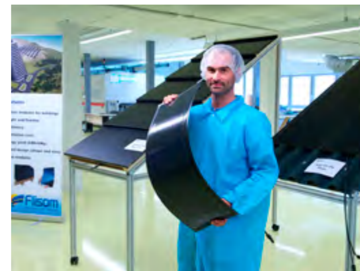
Bild rechts: Flisom-Produktentwickler Roland Kern zeigt, wie aus flexiblen Flisom-Solarmodulen montagefertige Dachpfannen werden.
