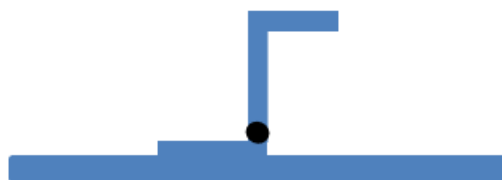
(d) Laser welded Stiffener (assembled)
