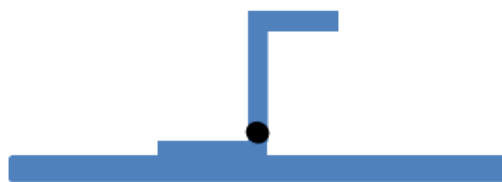
(d) Laser welded Stiffener (assembled)
